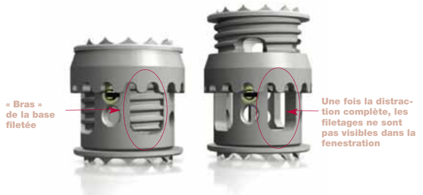
Figure 31 : La distraction complète de l'implant est obtenue lorsque les filetages ne sont plus visibles dans les fenestrations de l'implant.
